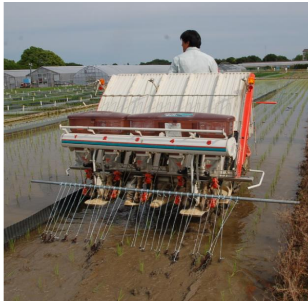
写真2-2. チェーンを6条用乗用田植え機のうしろにわたした鉄パイプに取りつけ牽引して いる様子
